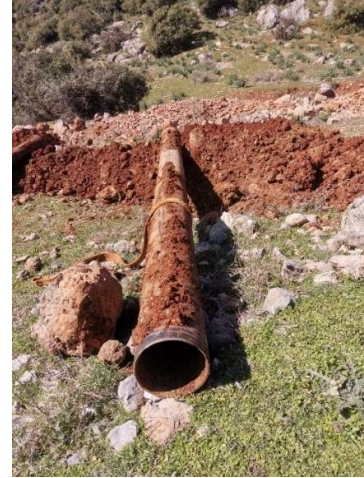
b) Nurdağında faylanma kaynaklı Ø300 isale hattı hasarı (düktül boru)
