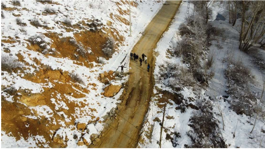
b) Elbistan-Ekinözü fay yüzey kırığı, kaya düşmesi ve yolda görülen atım
