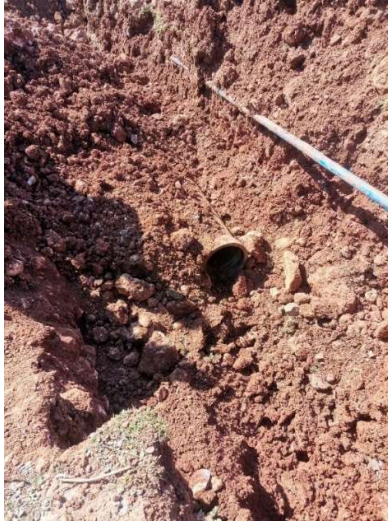
b) Nurdağında faylanma kaynaklı Ø300 isale hattı hasarı (düktül boru)
