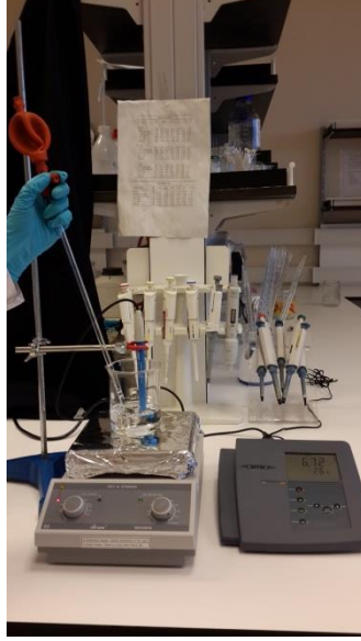
Şekil 7.1. pH Titrasyonu için kullanılan deney düzeneği
